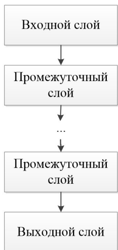
Рис. 1. Структурная схема нейронной сети. Значения признаков анализируемого объекта преобразуются пошагово, выходной слой возвращает метку, назначенную объекту
